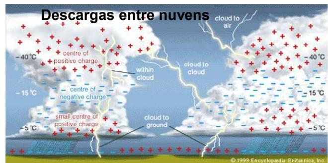
Fig. 2. Formação das descargas atmosféricas (adaptação).
